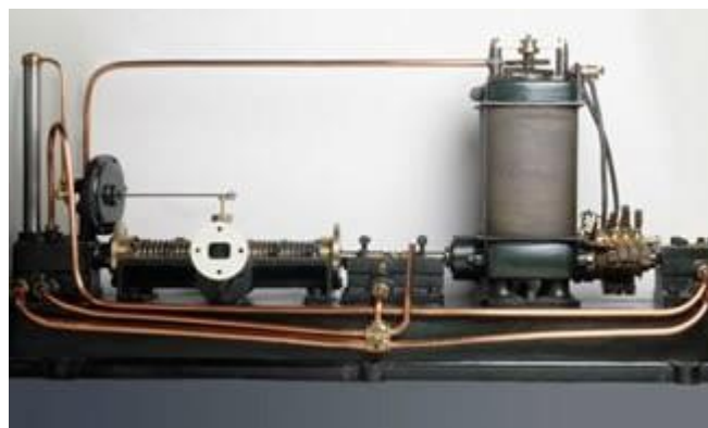
Slika 6. Parsonsova parna turbina[2]
