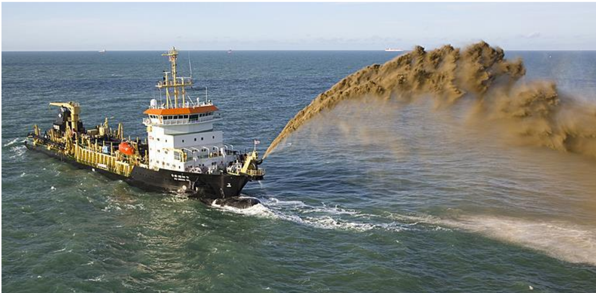
Slika 1. Iskrcaj tehnikom naštrcavanja, eng.: rainbowing [3]
