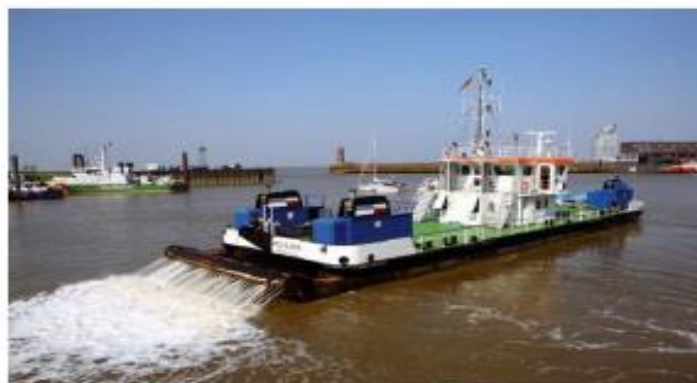
Slika 10. Jaružalo s uštrcavanjem vode pod tlakom [8]
