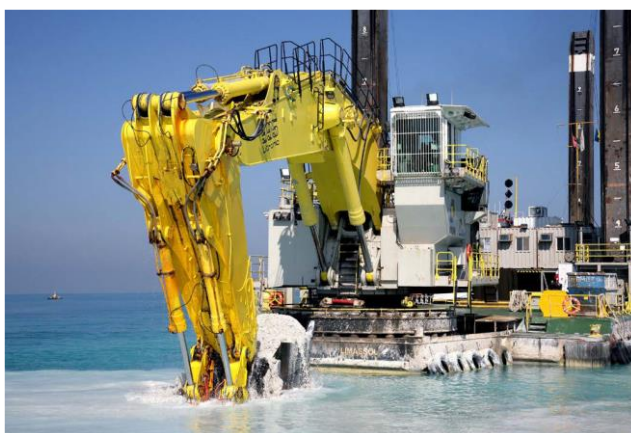
Slika 28. Backacter 1100, najveće jaružalo s dubinskom lopatom, sa sustavom elektroničkog pozicioniranja [27]
