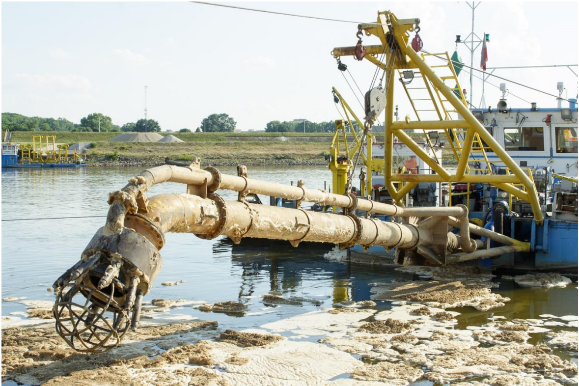
Slika 38. Usisna usta običnog usisnog jaružala [21]
