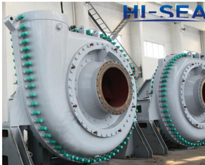
Slika 49. Pumpa za jaružanje s dvostrukom stijenkom proizvođača Hi-Sea Marine [17]
