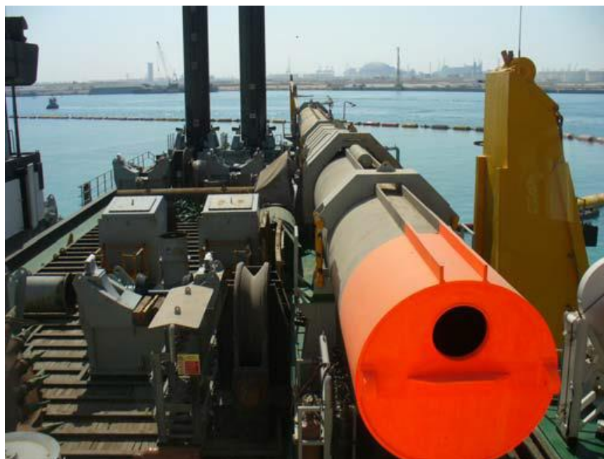
Slika 63. Glavni i pomoćni pilon u uspravnom položaju, rezervni u položaju morskog veza [9]
