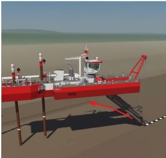
Položaj 3 - glavni je pylon za uzdužni pomak broda udaljeniji od glave sjekača (veći radijus) i zatezanjem lijevog čeličnog kabela, počinje se opisivati novi koncentrični kružni luk. Proces se ponavlja dok kolica pilona ne dođu u krajnji položaj.
