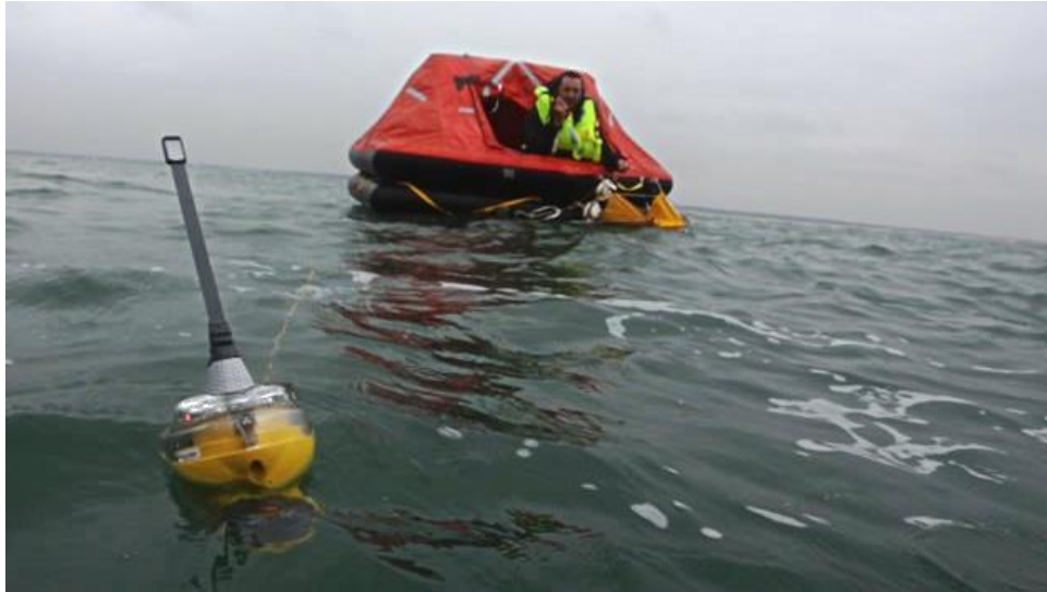
Slika 8. Prikaz primjene EPIRB plutače u stvarnoj situaciji [16]
