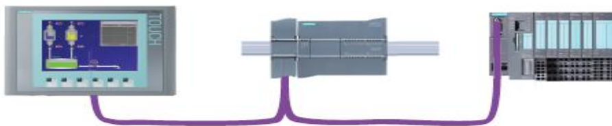
Slika 10. S7-1200 spojen kao nadređeni uređaj koja upravlja ET200S [1]
