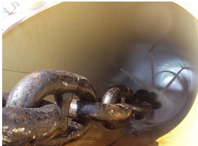
Slika 13. Pranje sidrenog lanca u sidrenom ždrijelu [9]
