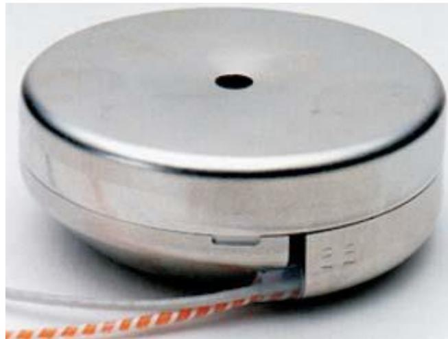
**Slika 7: Žiroskop s optičkim vlaknima firme
