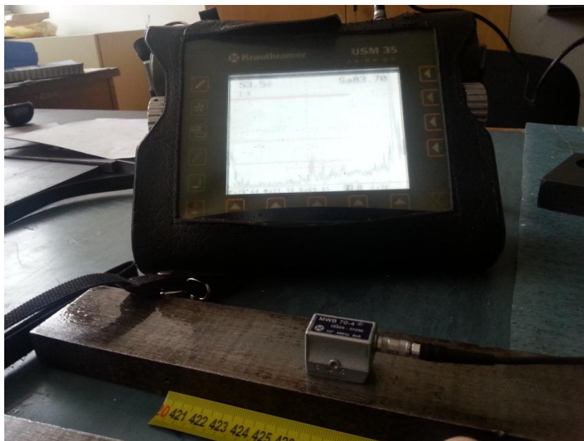
Slika 30. Priprema za određivanje izlazne točke
