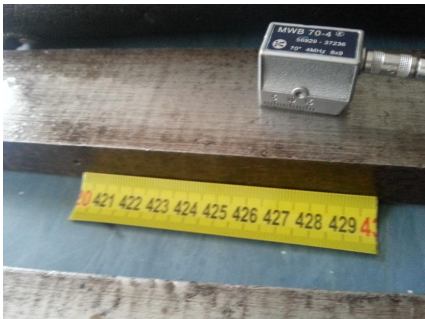
Slika 32. Očitavanje udaljenosti izlazne točke sa mjerne trake
