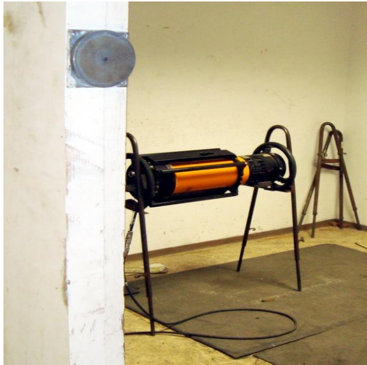
Slika 7. Rendgen unutar zidova s olovnim pločama; zavarivački laboratorij 'Brodosplit'
