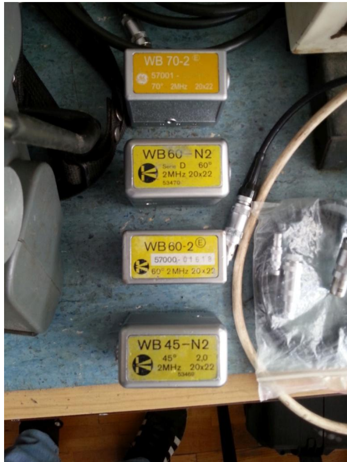
Slika 26. Kutne sonde Wb 45-2, WB 60-2, WB 70-2
