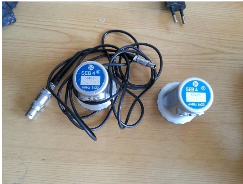
Slika 24. Sonda sa dva pretvarača. Model SEB 4
