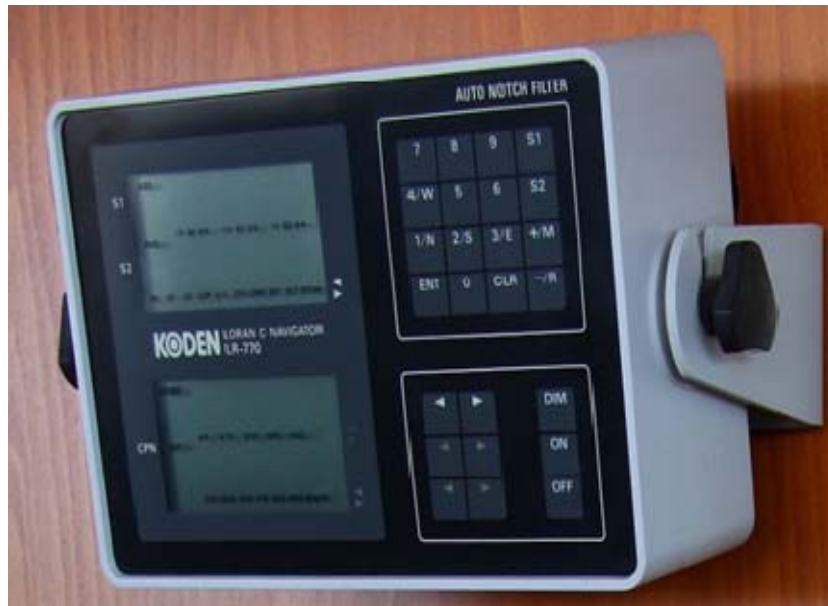
Slika 1. LORAN primač signala [21]
