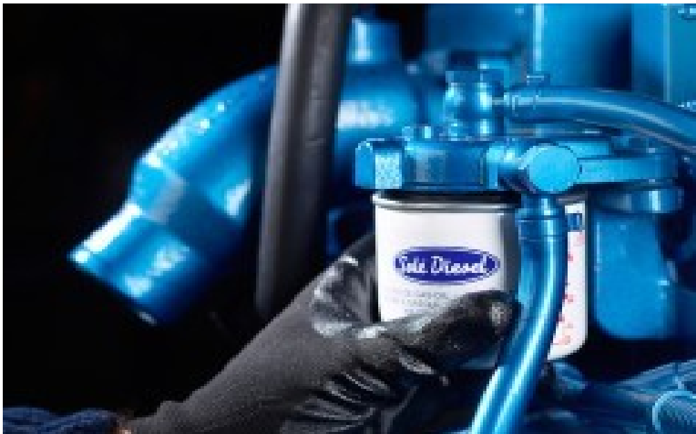
Slika 8. Zamjena filtra ulja
