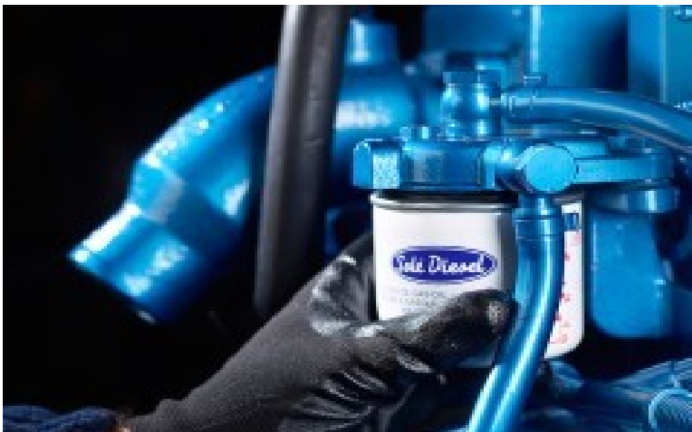
Slika8. Zamjena filtra ulja
