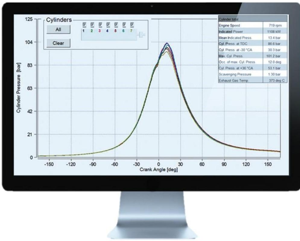
Slika 19. Dijagram kontrole tlakova izgaranja u cilindrima motora [6]
