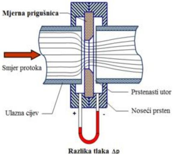
**Slika 11. Mjerna prigušnica prema standardu ISO 5167 za mjerjenje protoka [12]**
