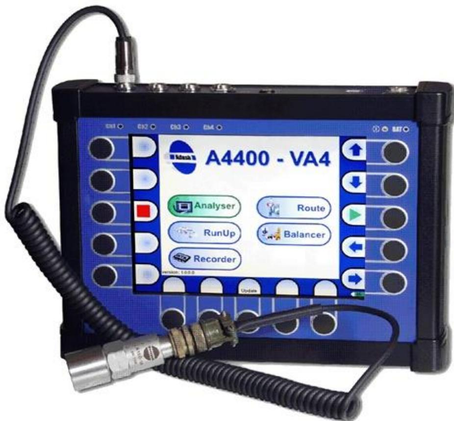
Slika 15. Analizator vibracija VA4PRO [14]
