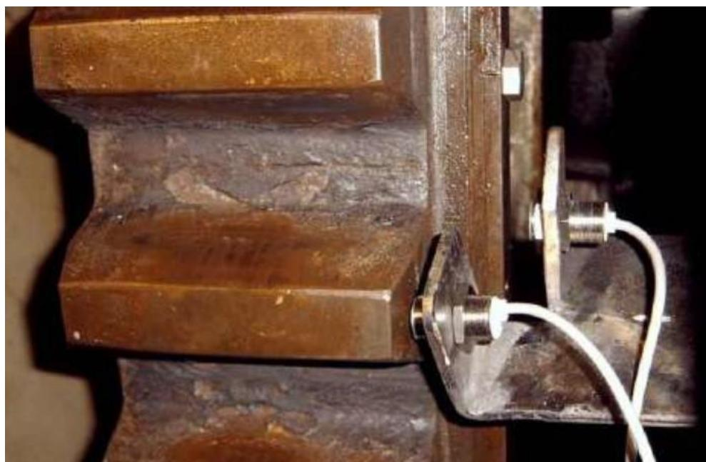
**Slika 14. Induktivni davač brzine vrtnje [4]**
