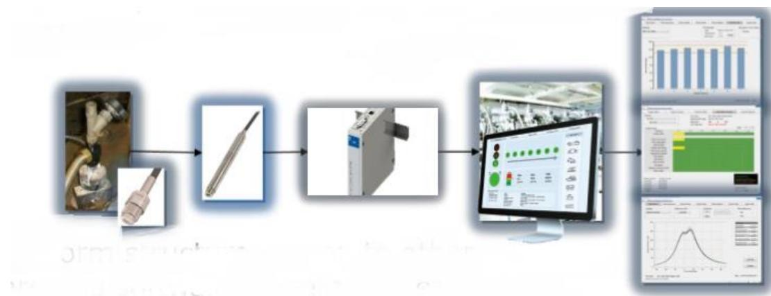
**Slika 21. AVL EPOS lanac mjerjenja [9]**
