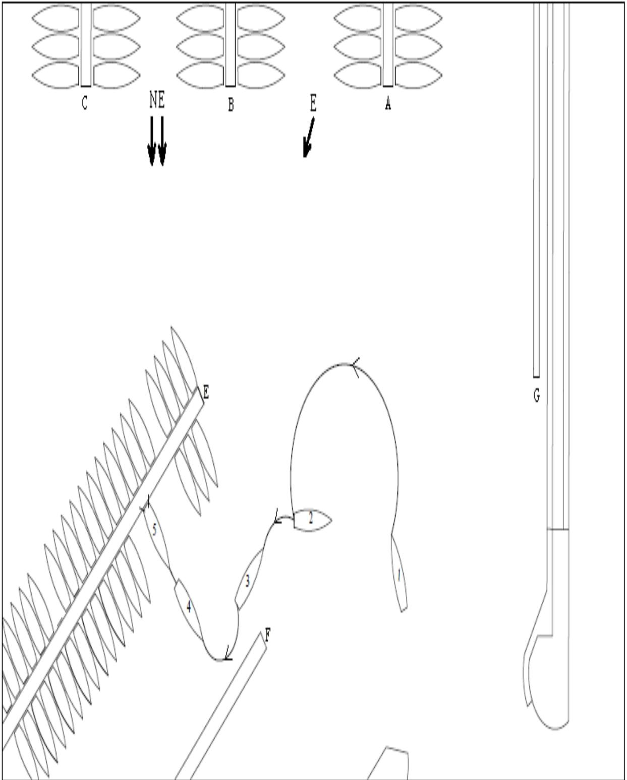
Slika 24. Uplovljavanje na desnu stranu gata-E (sjeverno-istočni i istočni vjetar) [15]
