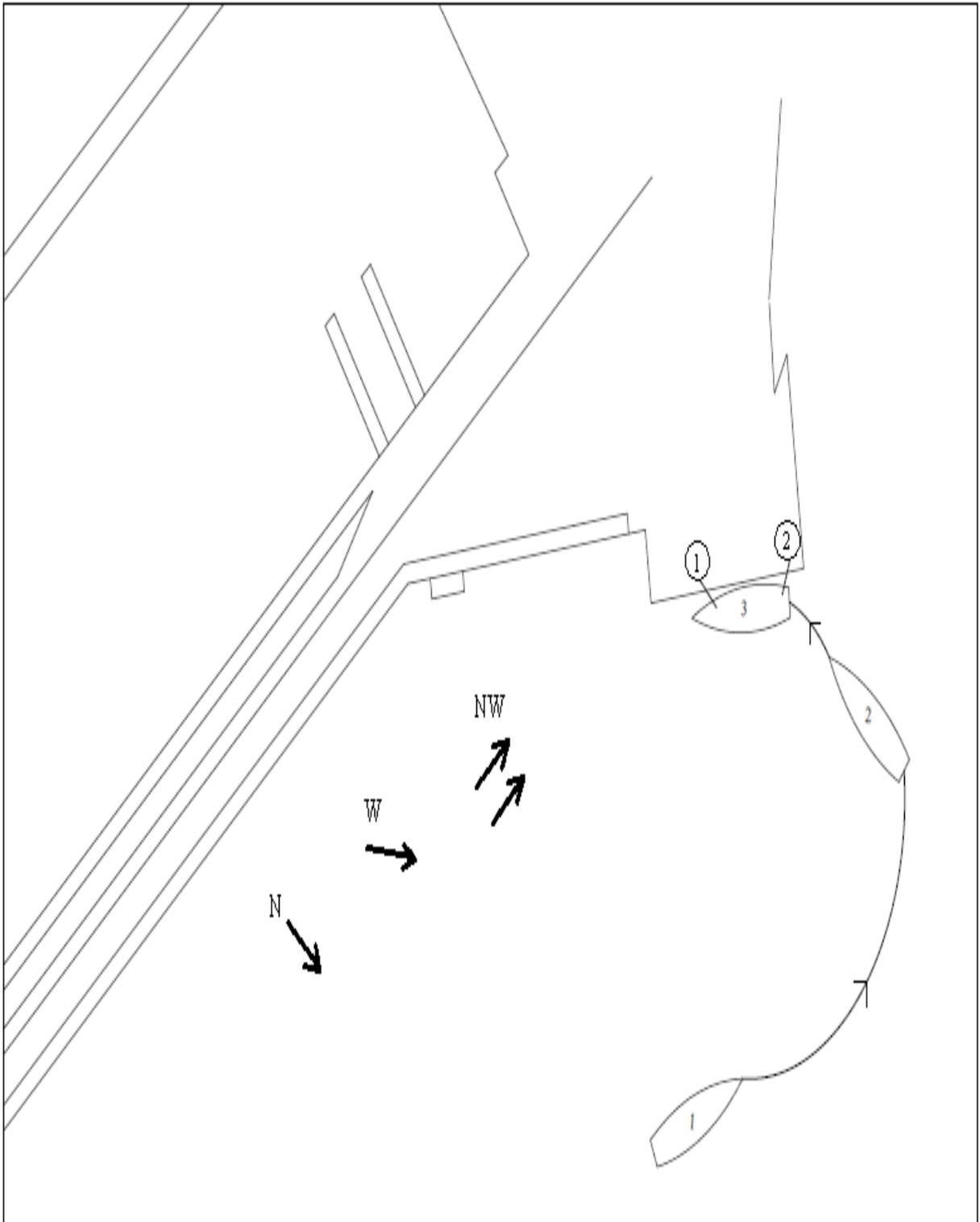
Slika 37. Pristajanje jedrilicom na benzinsku postaju (sjeverno-zapadnjak, zapadnjak i sjeverac) [15]
