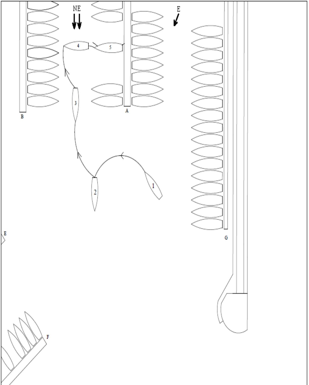
Slika 14. Uplovljavanje na desnu stranu gata-A (sjeverno-istočni i istočni vjetar) [15]
