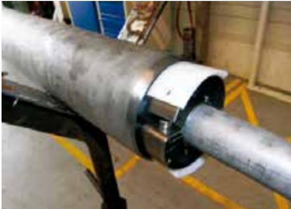
Slika 21. Izrada cijevi sa dvostrukom stjenkom [5]
