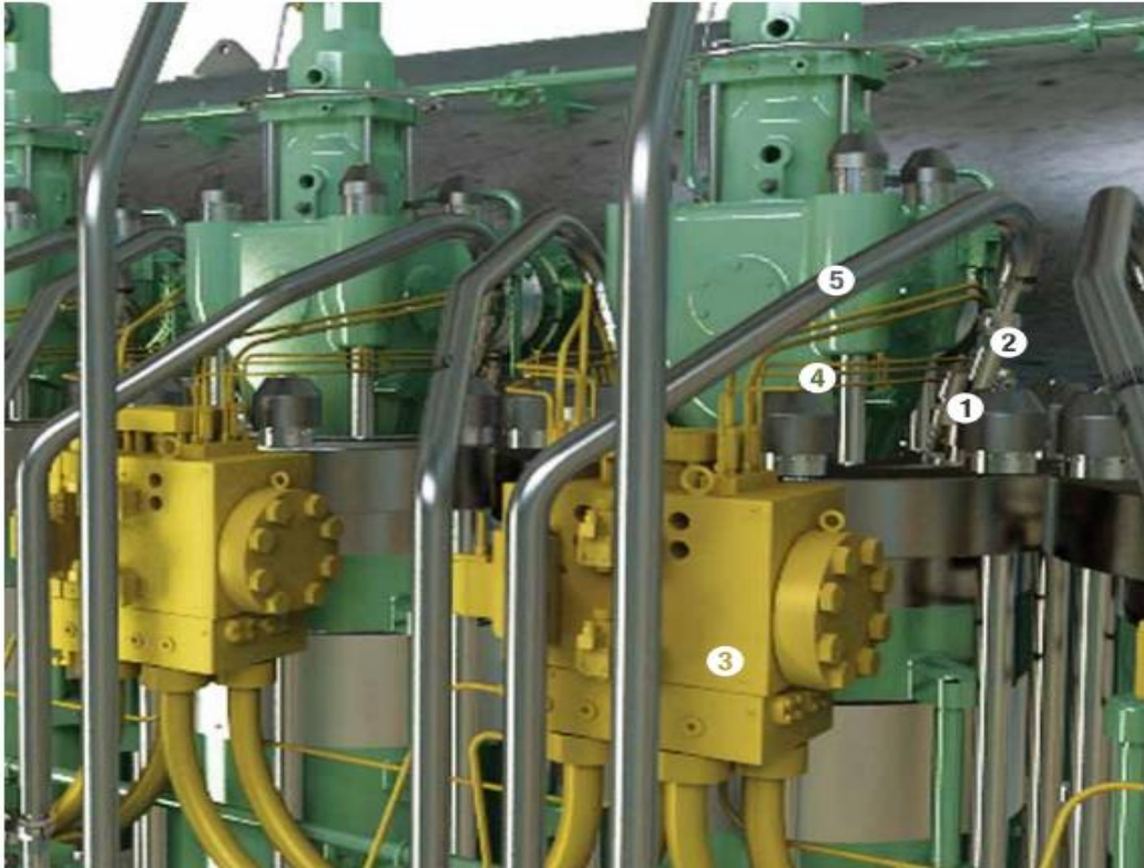
Slika 24. Poklopac cilindra sa svim elementima za ubrizgavanje dvojnog goriva (DF) [1]
