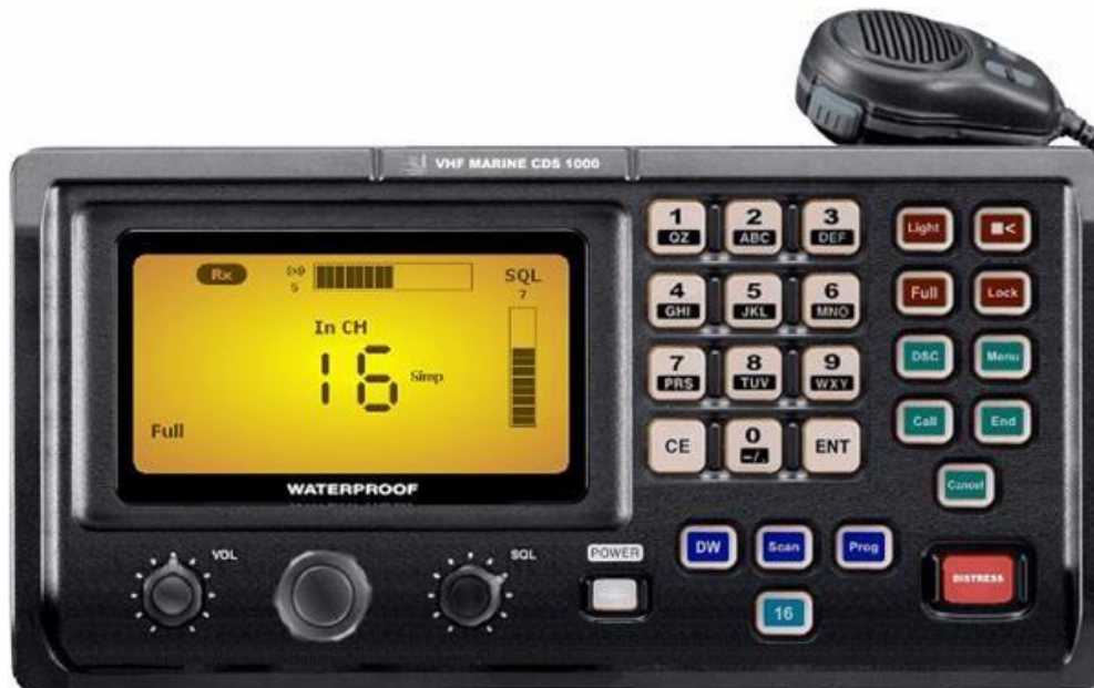
Slika 3. VHF DSC terminal [20]
