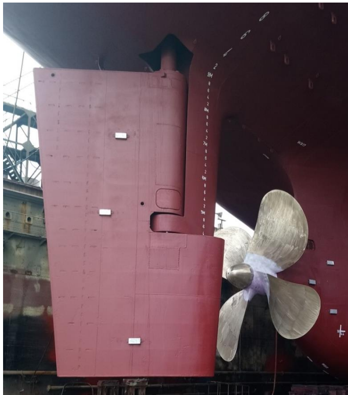
Slika 18. Vijak i kormilo M/T Primjer 1
