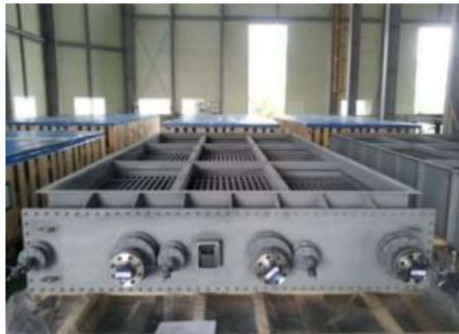
Slika 8. Zagrijač zraka za plinsku turbinu [8]
