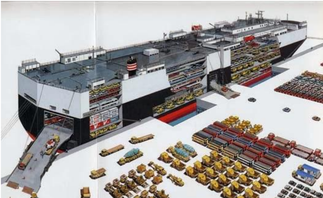
Slika 13. Prikaz utovara tereta na RO-RO brod [6]
