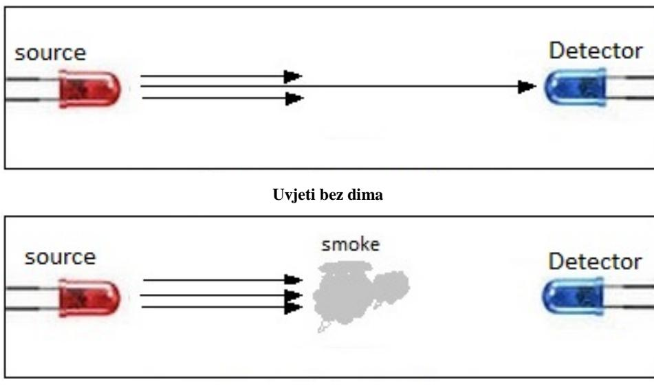
**Slika 6. Princip apsorbirane svijetlosti**
