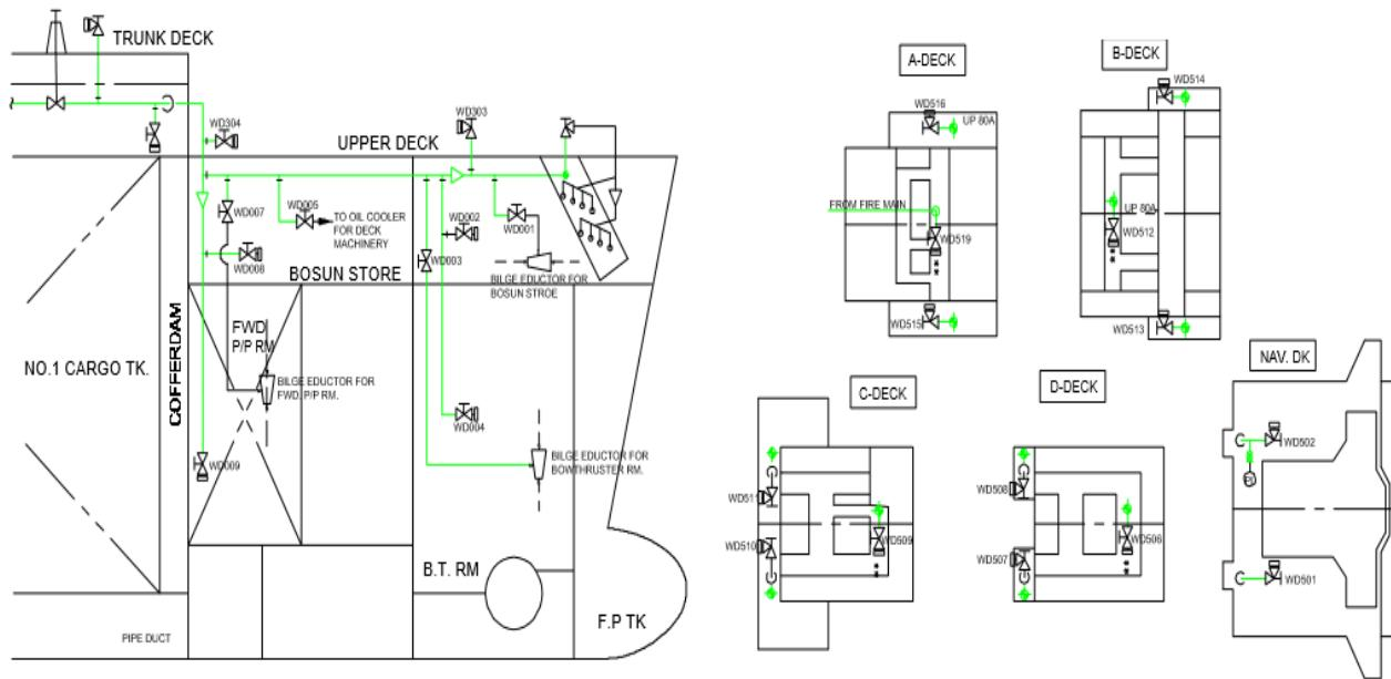
**Slika 15. Raspored vodova i hidranta po palubama (GOLAR ltd. Machinery manual)**
