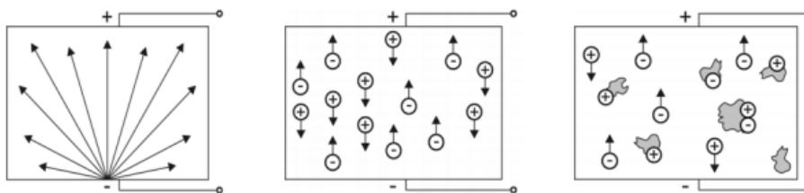
**Slika 7. Detekcija principom ioniziranog zraka**
