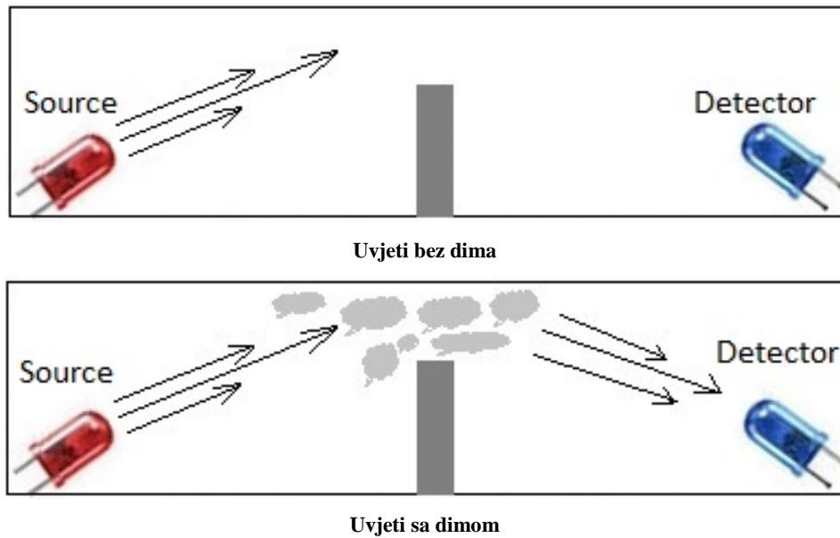
**Slika 5. Princip reflektirane svijetlosti**
