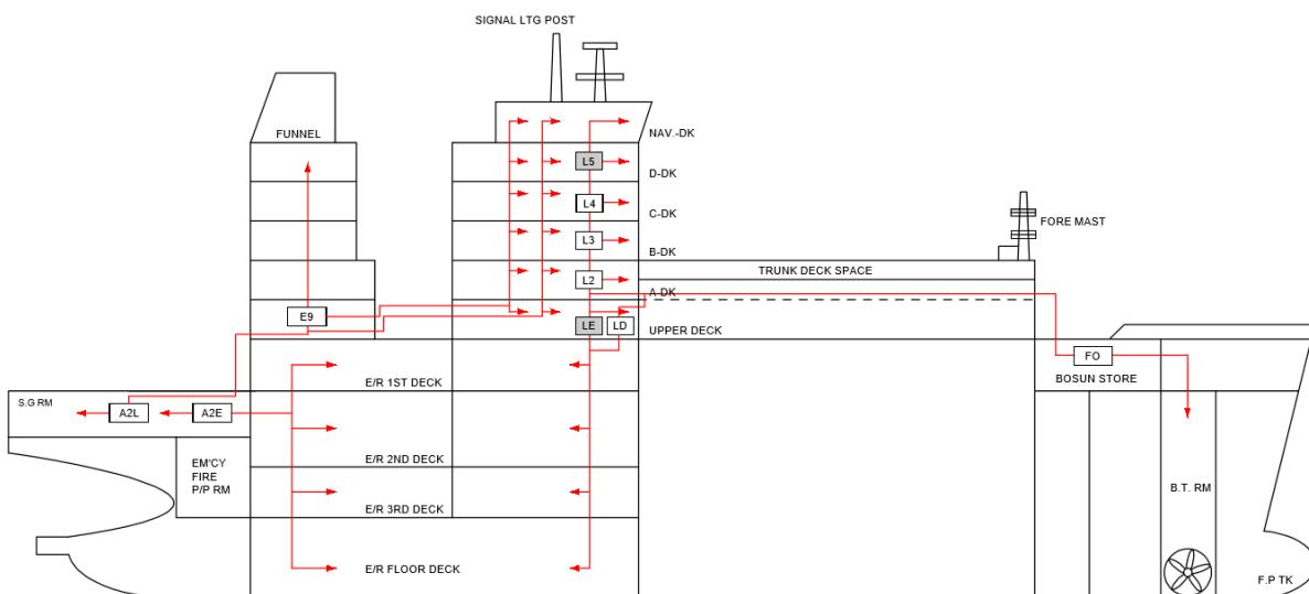
Slika 3, načelna shema sustava detekcije (GOLAR ltd. Machinery manual)
