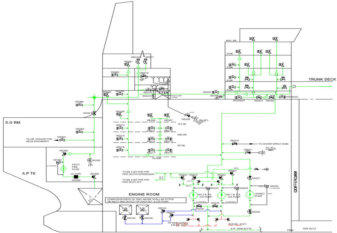
**Slika 13. Glavni protupožarni vod, glavne pumpe i pomoćna pumpa
