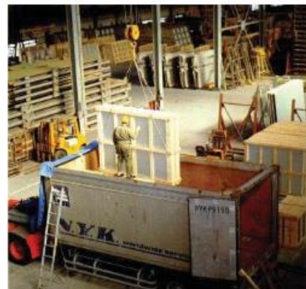
Slika 5. Kontejner s otvorenim krovom i stranicama
