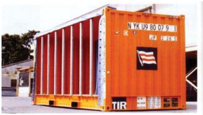
Slika 5. Kontejner s otvorenim krovom i stranicama
