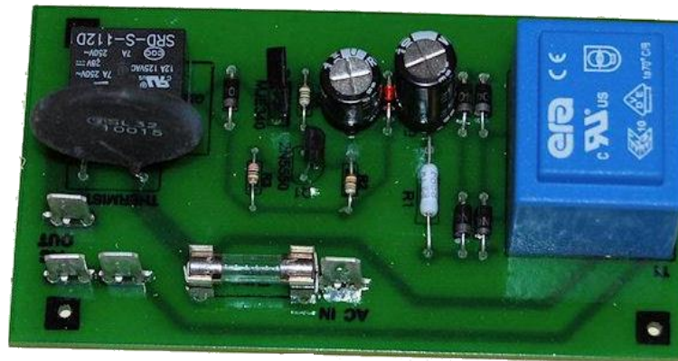
Slika 4.1 Jednoslojna tiskana pločica
