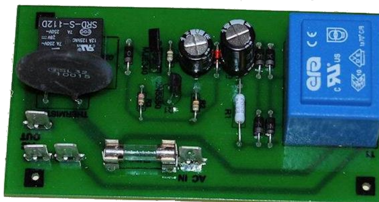
Slika 4.1 Jednoslojna tiskana pločica
