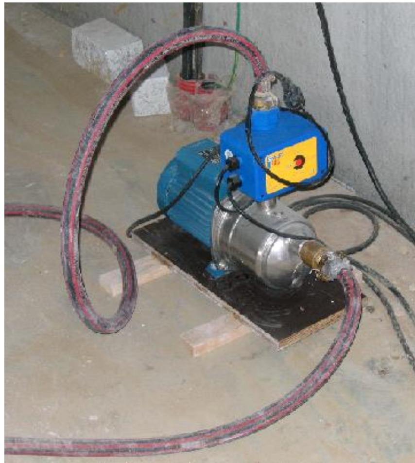
**Slika 5. Pumpa na električni pogon**
