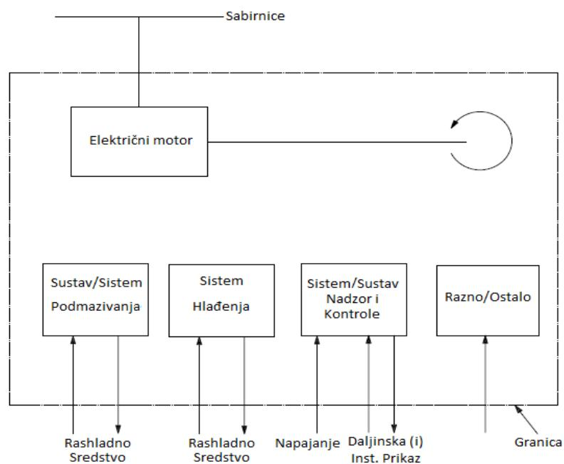
**Slika 8. Definiranje elemenata (granica) opreme, električni motor [10]**
