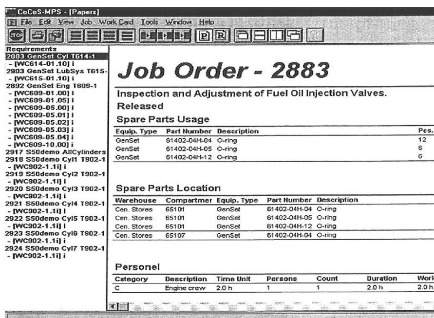
Slika 18. Radni nalog u "CoCoS" – MPS [9]
