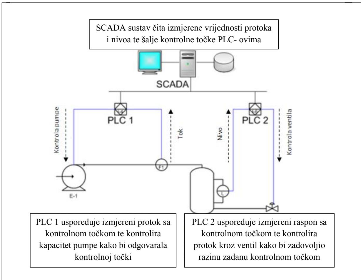
**Slika 24. Shematski prikaz sustava za nadzor razine [15]**
