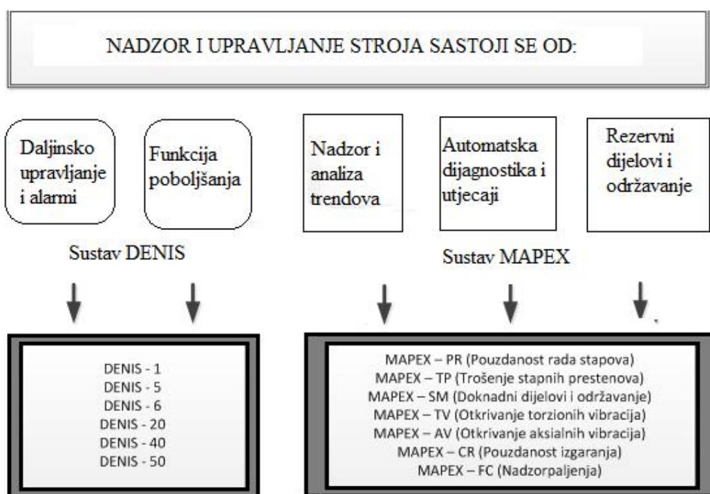
**Slika 21. Prikaz sustava upravljanja motorom, rada s njim, dijagnostike i održavanja**
