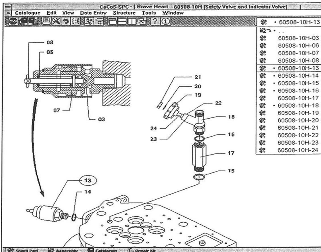
Slika 20. Princip traženja dijelova u CoCoS sustavu [8]
