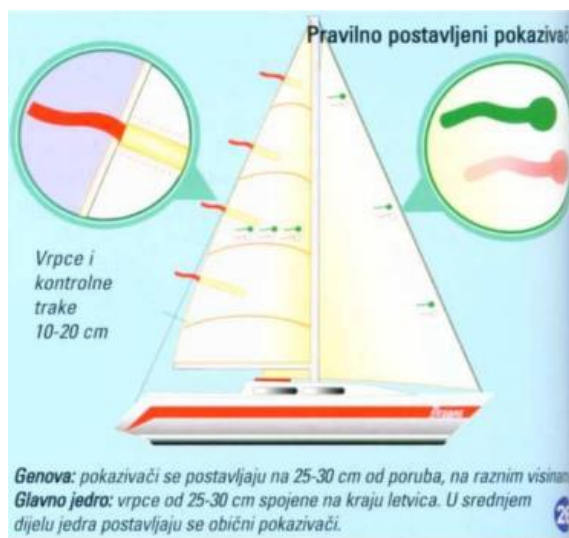
Slika 15. Pravilno postavljeni pokazivači vjetra [3]
