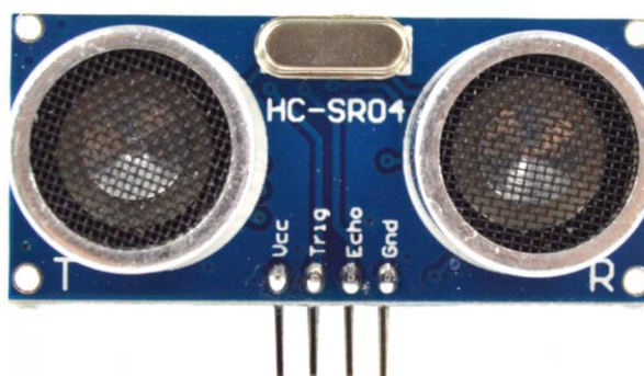
Slika 21. HC-SR04 ultrazvučni senzor
