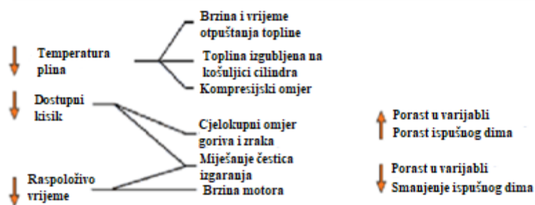
Slika 21. Parametri dizelskih motora koji utječu na formiranje čađe i oksidaciju [2]
