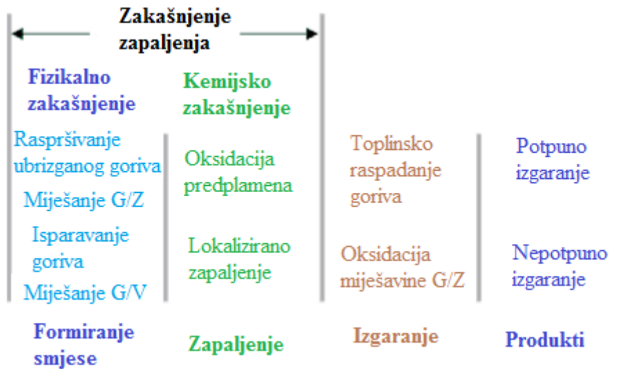
Slika 12. Sažetak koraka prije i poslije samozapaljenja [2]
