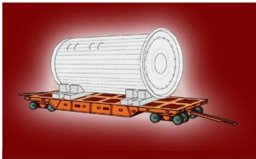
Slika 4. Spuštena sklopiva ro-ro prikolica[22]
