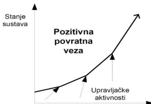
Slika 11. Funkcioniranje pozitivne povratne veze [1]
