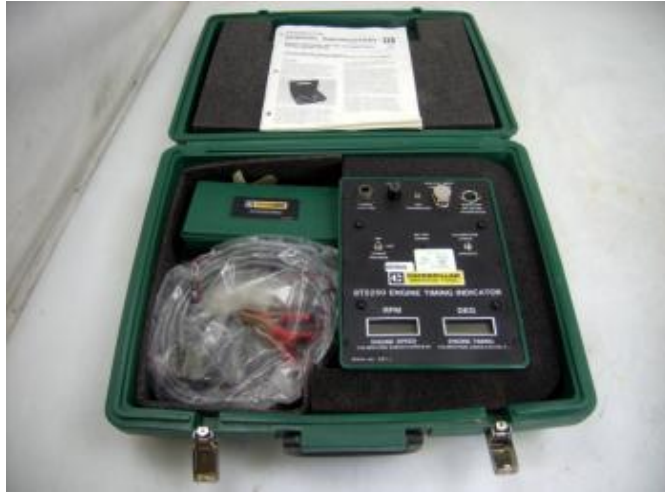
Slika 22. Indikator trenutka ubrizgavanja goriva [2]
