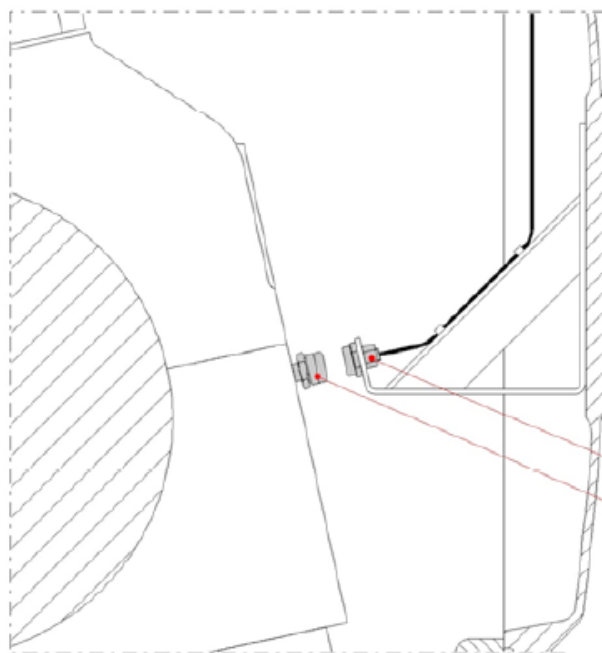
Slika 32. Instalacija bežičnog senzora [14]
