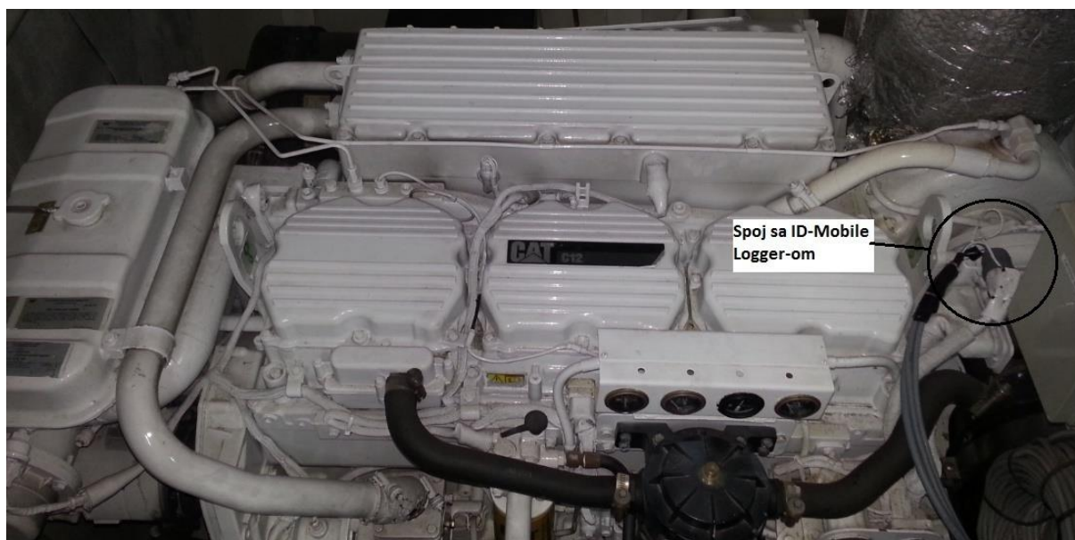
Slika 63. Brodski motor Caterpillar C12
