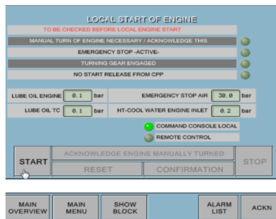
Slika 31. Pokretanje generatora preko LOP-a
