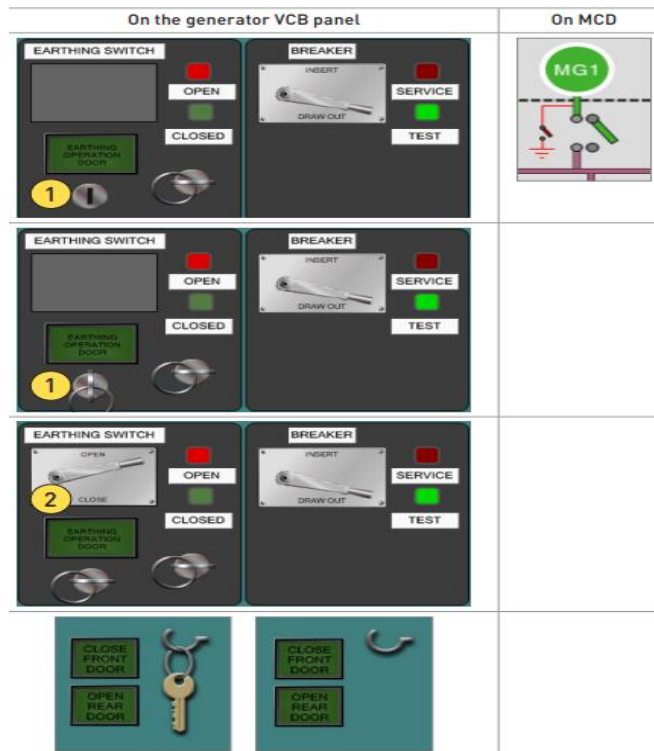
Slika 23. Uzemljenje visokonaponskog prekidača generatora
