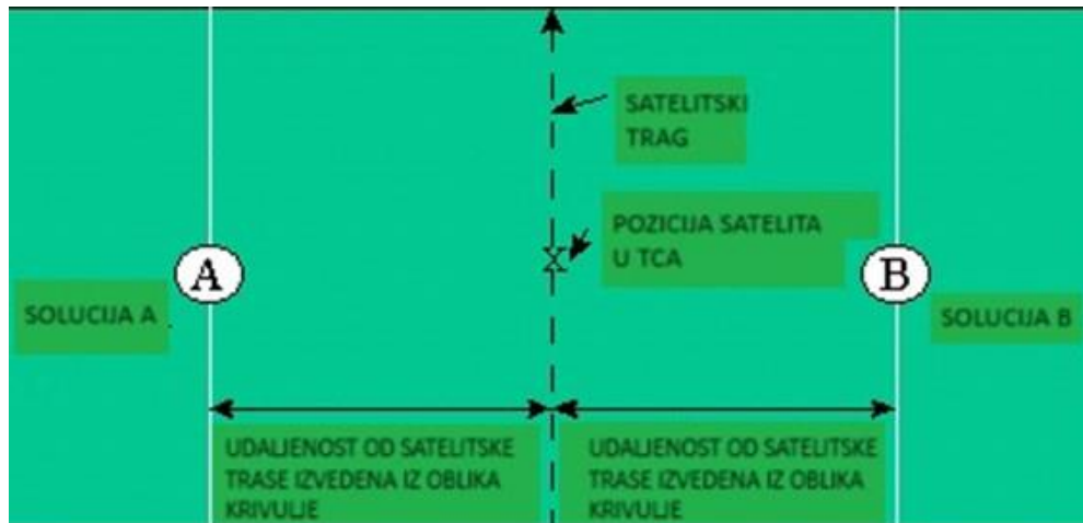
Slika 12. Objašnjenje Dopplerove obrade [19]
