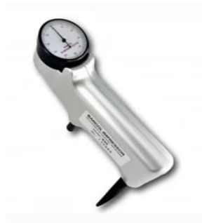
Slika 30. Barcol uređaj za ispitivanje tvrdoće [18]
