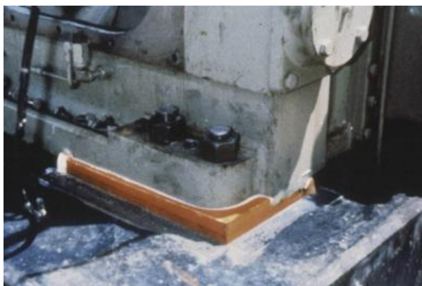
Slika 1. Podlošci od epoksidne smole [1]
