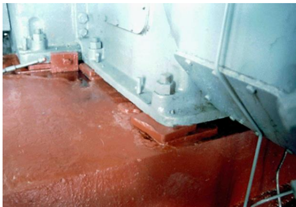
Slika 6. Temeljenje lijevanim željeznim podloščima [1]
