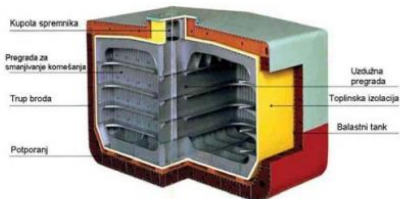
Slika 11. Prizmatski tank [16]
