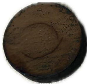
Slika 21. Pukotina na uzorku "Kaljenje vodom".
