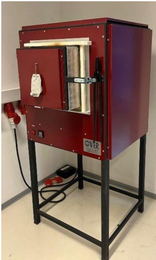
Slika 16. Peć za toplinske obrade s kontrolorom XMT-808 P.
