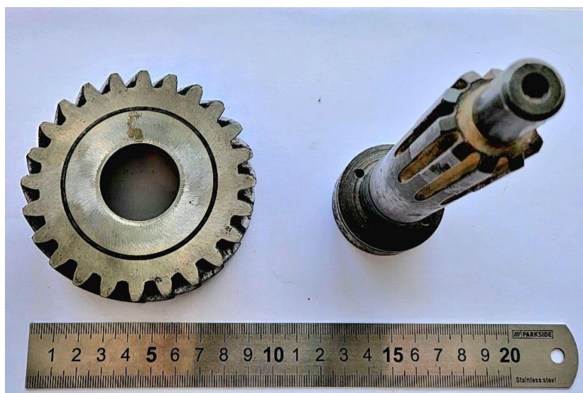
Slika 12. Glavni zupčanik nakon rezanja
