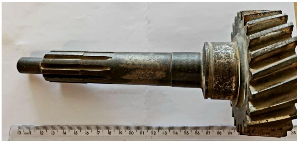
Slika 10. Prikaz glavnog zupčanog prijenosa prije rezanja
