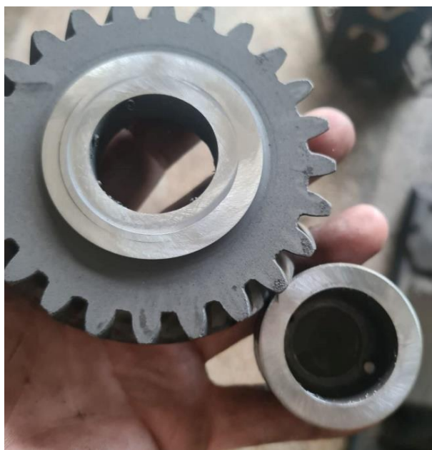
Slika 13. Odvojeni zupčanik i vratilo nakon ravnanja
