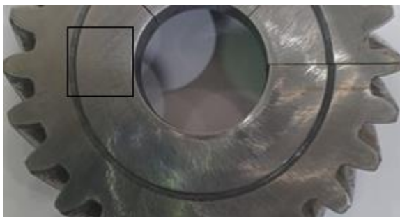
Slika 26. Područje (crni kvadrat) gdje je izmjerena tvrdoća
