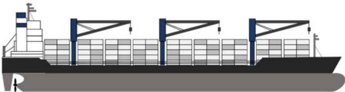
Slika 32. Shematski primjer kontejnerskog broda duljine 195 m i nosivosti 30 000 dwt, 2500 TEU [47]
