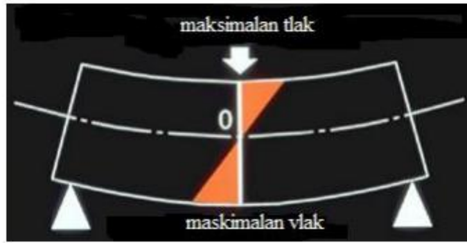
Slika 31. Shema opterećenja na savijanje [9]
