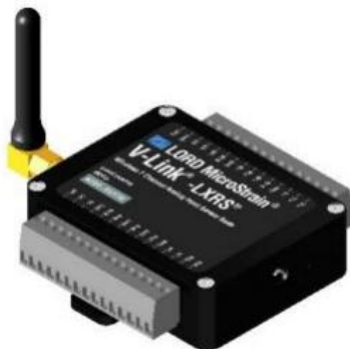
Slika 30. V-Link-LXRS bežični senzorski uređaj [8]
