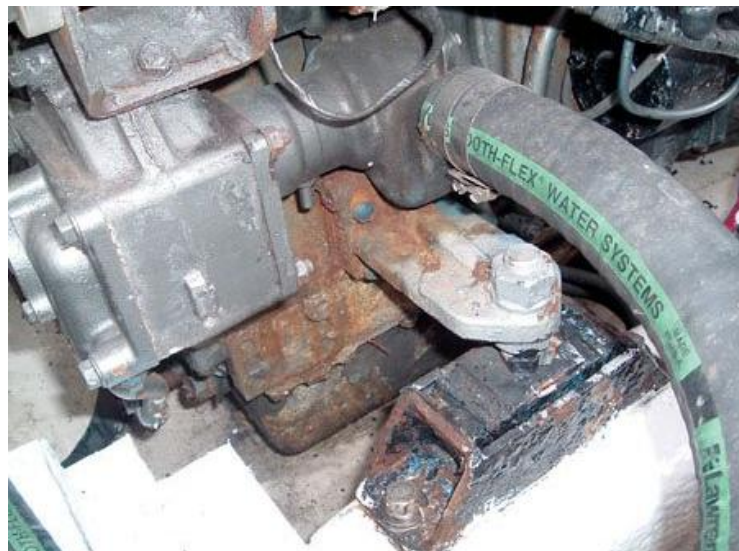
Slika 32. Korozija na dijelu strojnog uređaja [9]
