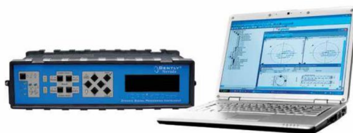
Slika 29. Uređaj za mjerenje vibracija Adre 408 SXP [10]
