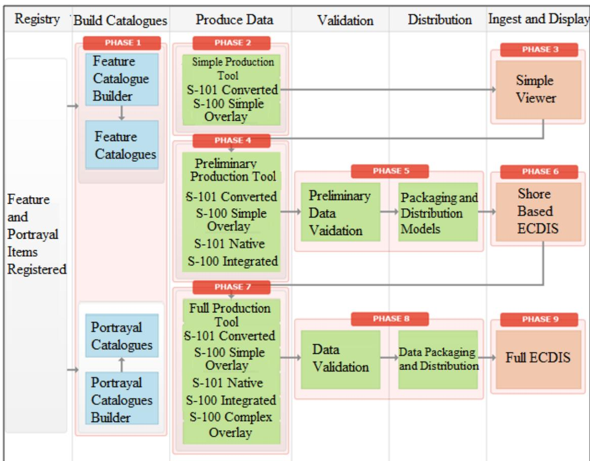
Slika 4. Faze podloge za testiranje standarda [42]
