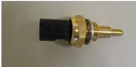
Slika 21. Osjetnik temperature ispušnih plinova [6]
