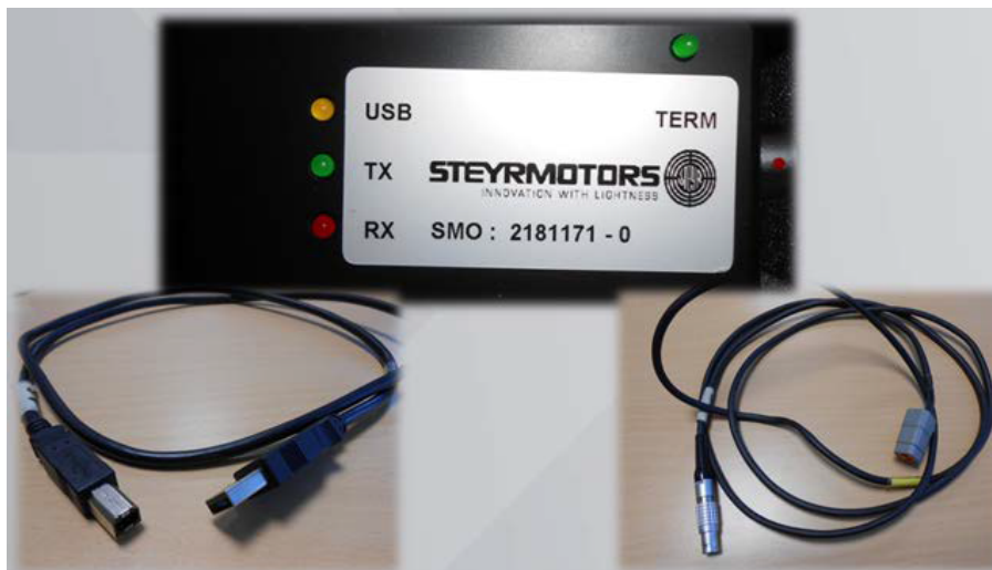
Slika 11. Modul za spajanje motora i dijagnostičkog alata [5]
