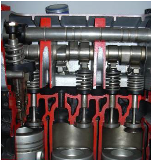
Slika 6. Presjek bloka motora [6]
