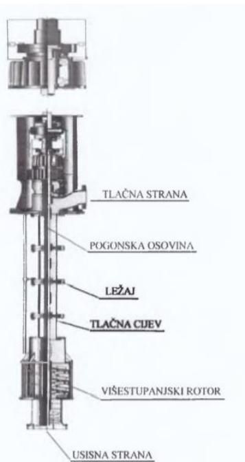
**Slika 23 Uronjiva pumpa s dugom osovinom [24]**
