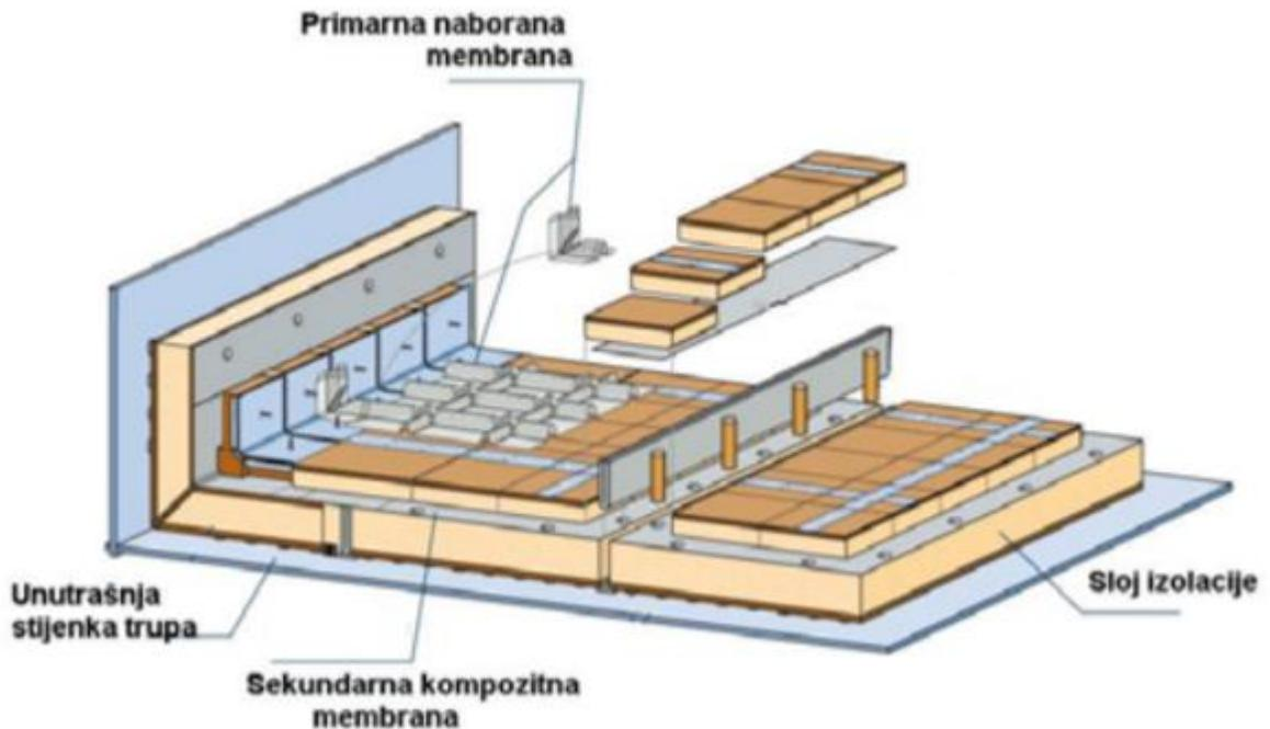
**Slika 14 Tip spremnika Technigaz Mark III. [19]**
