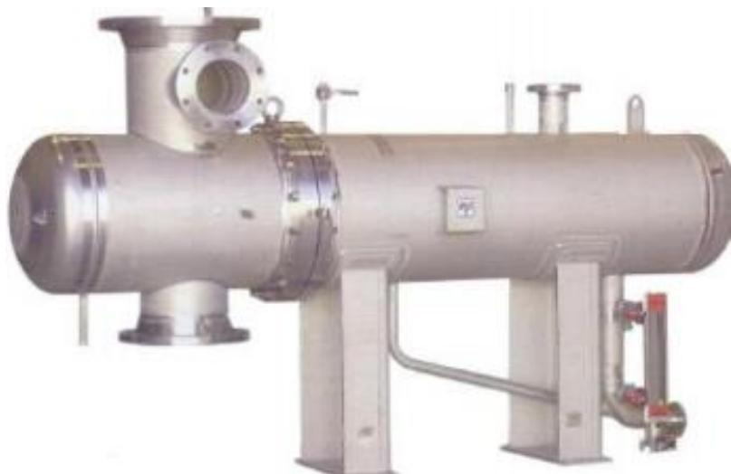
**Slika 27 Isparivač na LNG tankerima [26]**
