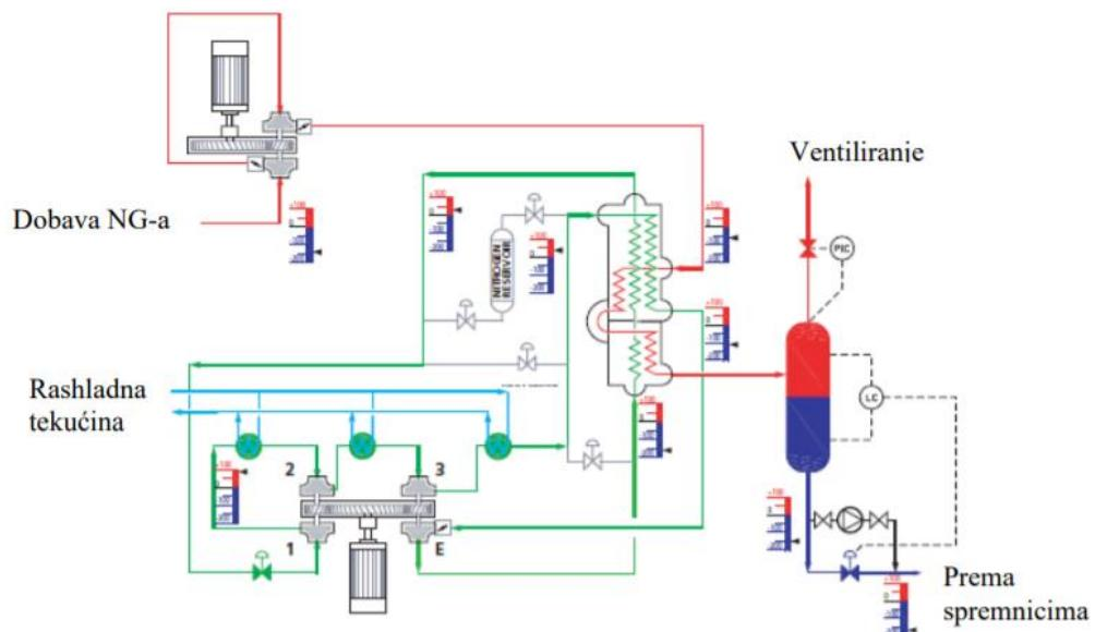
Slika 16 Sustav za ukapljivanje plina na LNG tankeru
