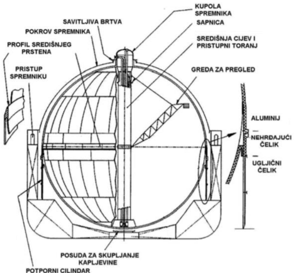
Slika 12 . Kuglasti spremnik [19]
