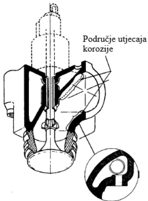
**Slika 31. Područje utjecaja korozije na kućište ispušnog ventila [2]**
