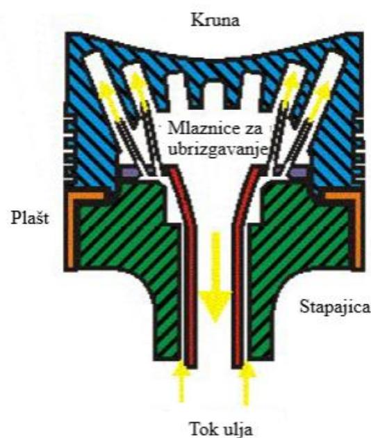
Slika 10. Stap dvotaktnog dizel motora sa križnom glavom [4]
