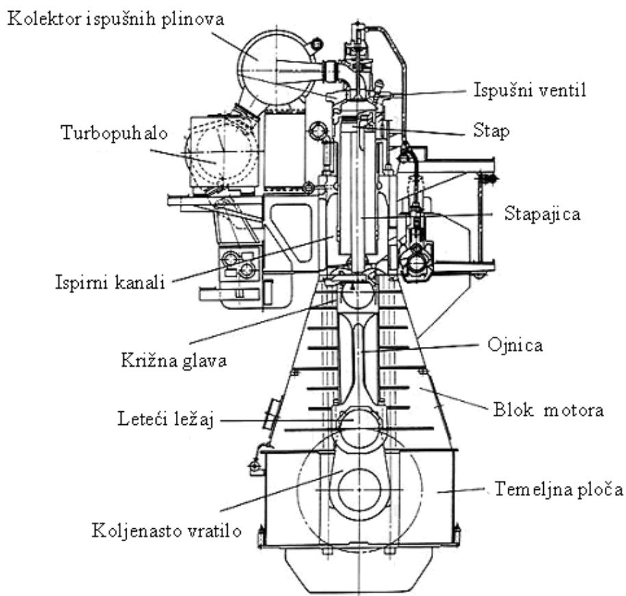
Slika 1. Presjek Diesel dvotaktnog motora MAN diesel & turbo [6]
