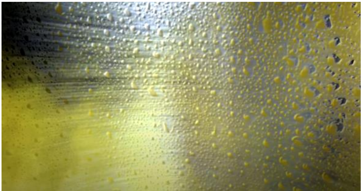
Slika 19. Kondenzacija na stjenkama košuljice cilindra [19]
