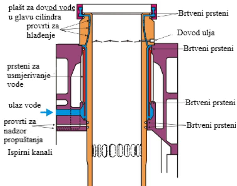
**Slika 9. Košuljica cilindra brodskog dvotaktnog sporohodnog dizelskog motora [4]**
