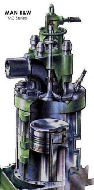
Slika 14. Glava cilindra dvotaktnog motora [7]
