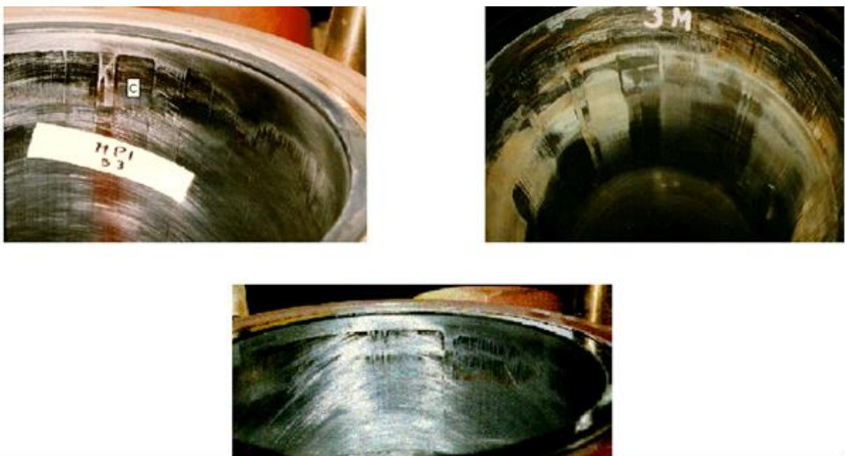
**Slika 17. Pepelom oštećene površine košuljica [10]**
