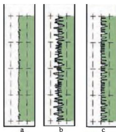
**Slika 30. Površina košuljice prije (a), nakon grube (b), te nakon fine završne obrade [18]**
