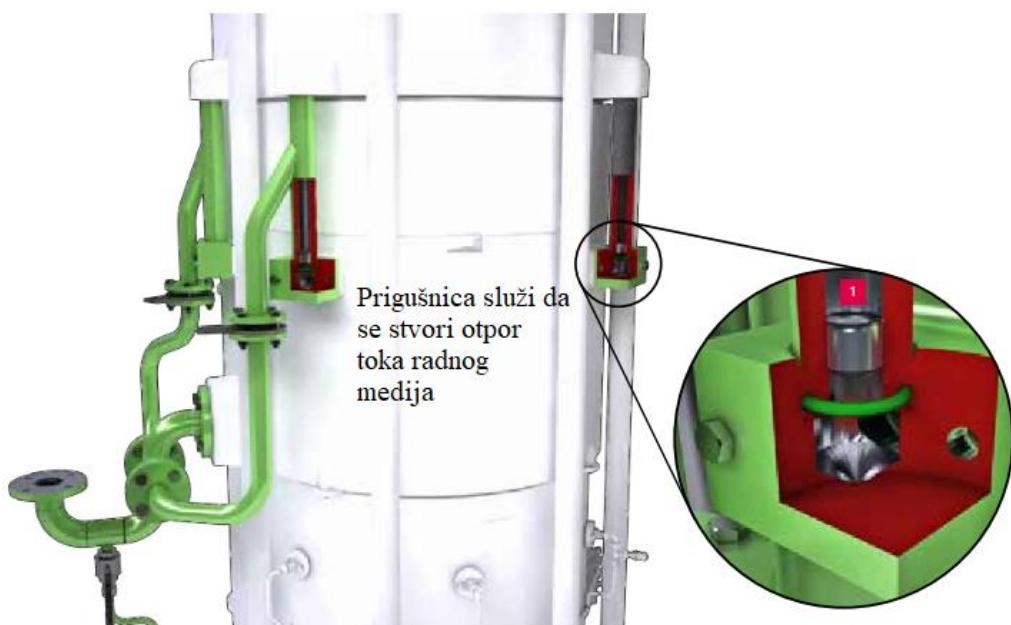
Slika 24. Sistem hlađenja košuljice rashladnom vodom obilaznim cjevovodom [15]
