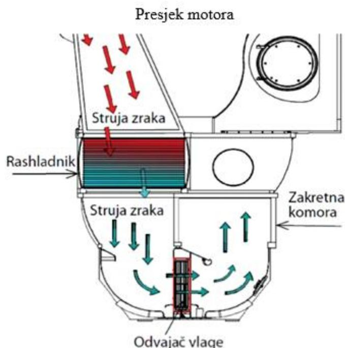
**Slika 28. Odvajač vlage iz ispirnog zraka [5]**
