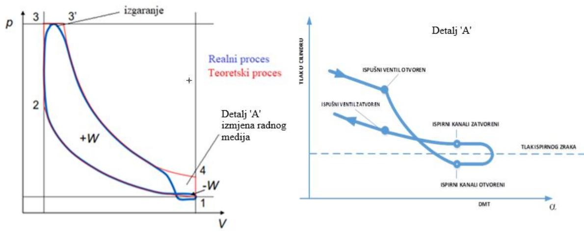
**Slika 3. Realni i teoretski p-V dijagram 2T motora te dijagram izmjene radnog medija u realnom procesu[4]**
