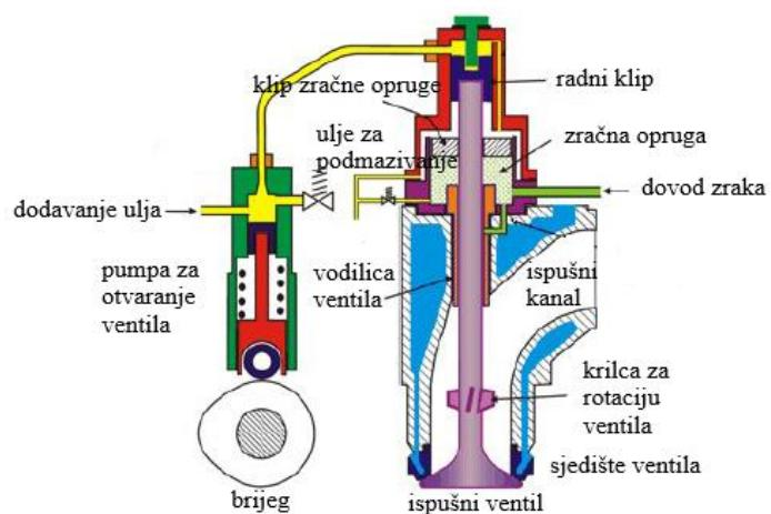
**Slika 15. Ispušni ventil brodskog dvotaktnog sporohodnog dizelskog motora s pneumatsko-hidrauličnim upravljanjem [8]**
