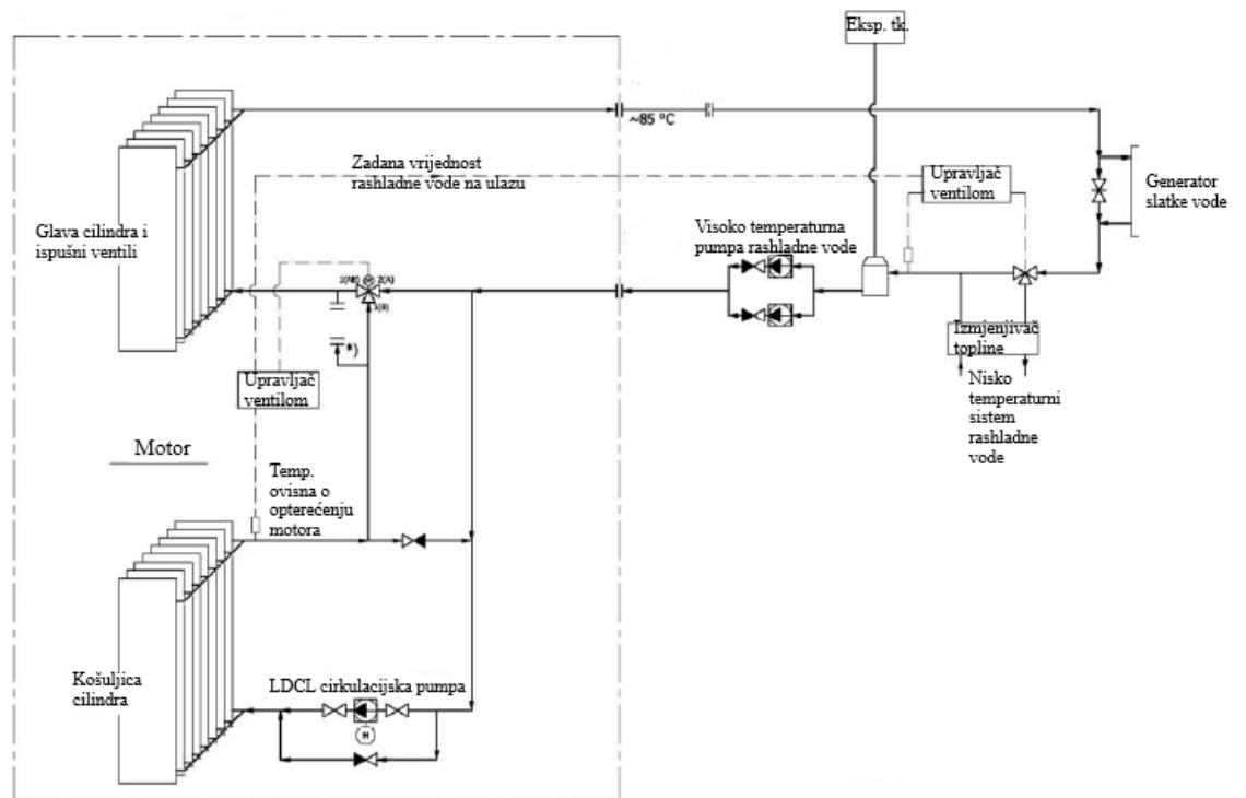
Slika 25. Shematski prikaz LDCL rashladnog sistema [16]
