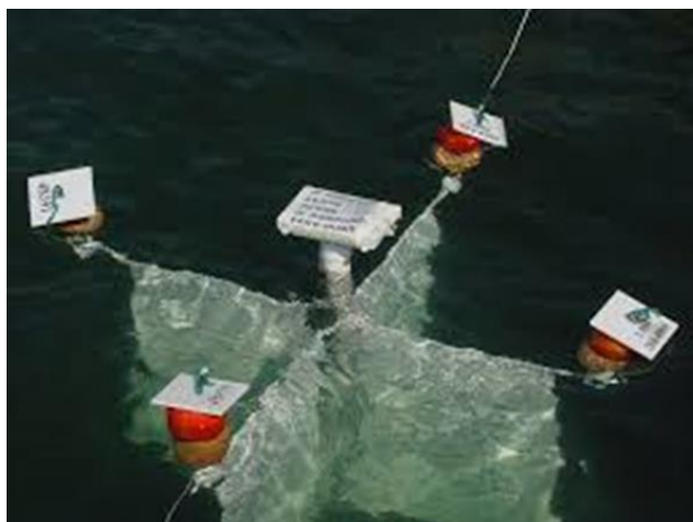
Slika 8. Langrangeova metoda – satelitski praćeni drifter [11]
