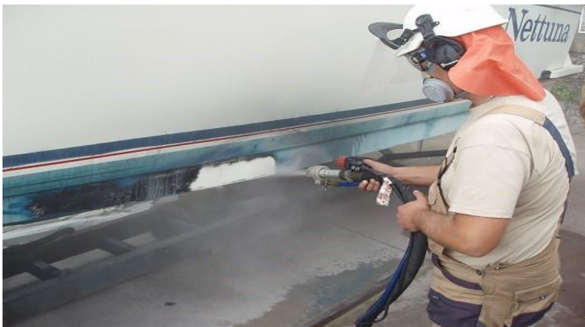
Slika 12. Pjeskarenje broskog trupa sodom [4]
