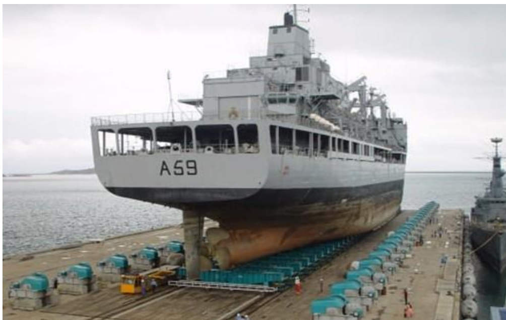
Slika 2. Brod u syncro-liftu [4]
