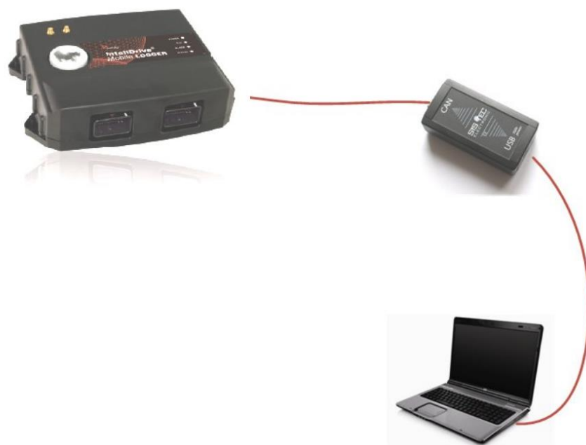
Slika 28. Shematski prikaz povezivanja računala s ID-Mobile-Logger-om pomoću CAN/USB pretvarača signala. [5]
