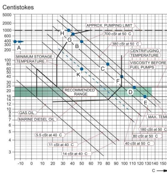
**slika 5. Odnos temperature i viskoziteta [4]**
