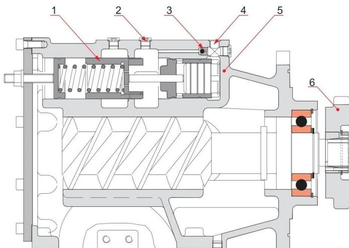
**Slika 14. Jedinica pumpe ulja za podmazivanje [5]**
