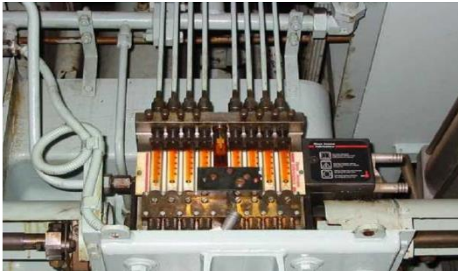
Slika 11 Mehanički podmazivač cilindarskih košuljica [16]
