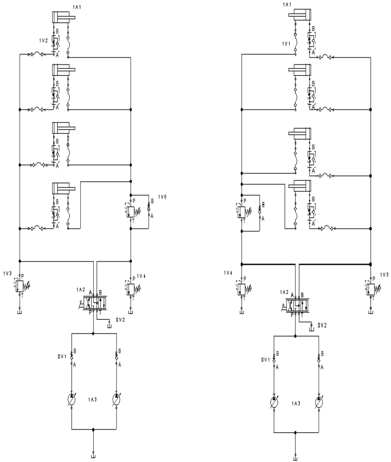
**Slika 23. Pojednostavljena shema hidrauličkog sustava za otvaranje i zatvaranje poklopaca grotala [13]**
