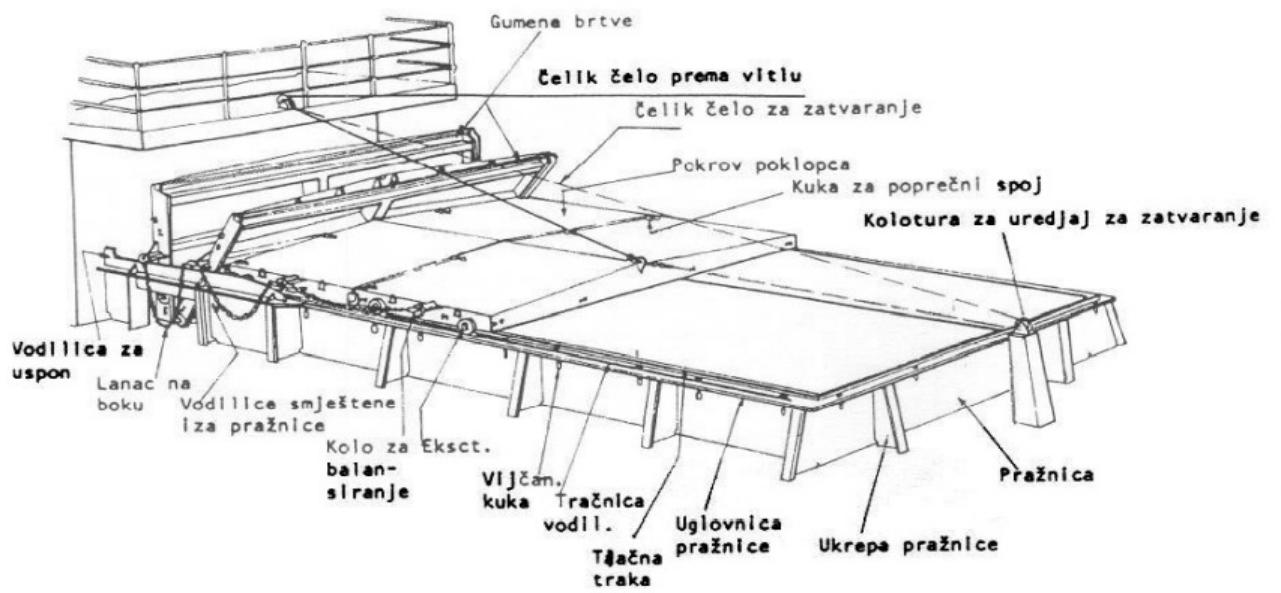
Glavni elementi opreme poklopca grotla za jednosmjerno povlačenje
