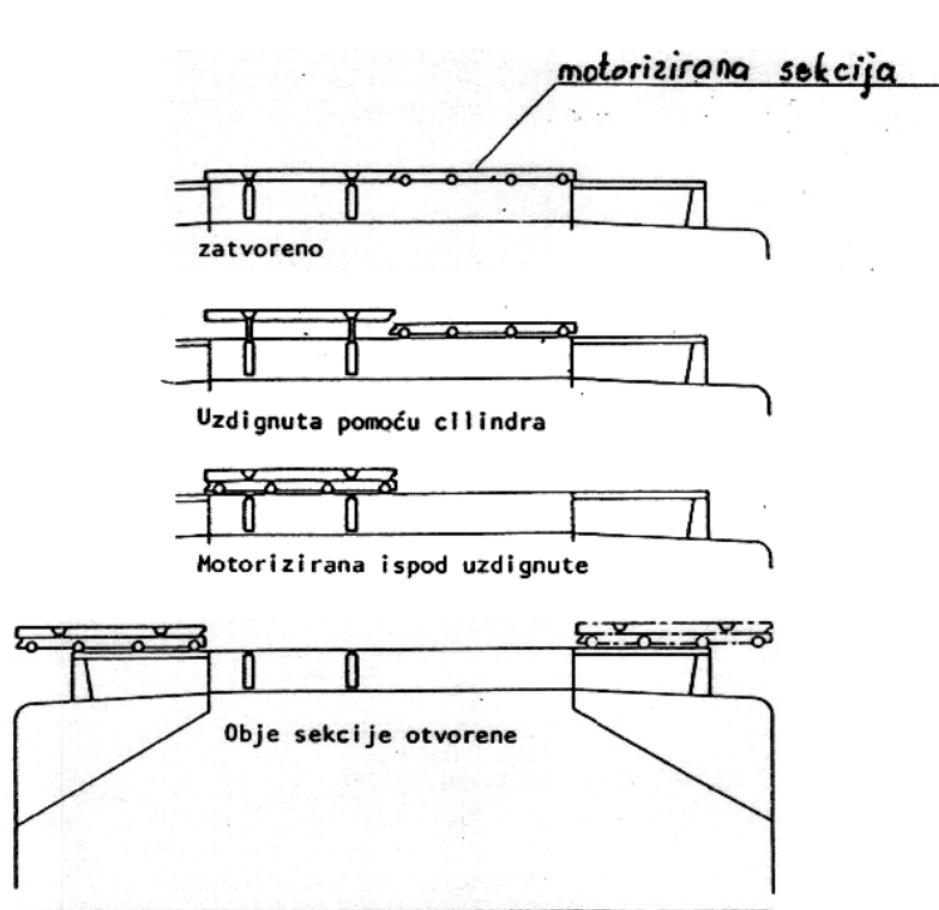
Slika 7. Primjer poklopca grotala za podizanje i kotrljanje [2]
