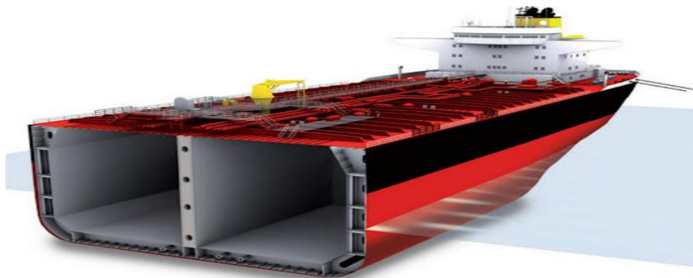
Slika 15. Presjek trupa s dvodnom [14]
