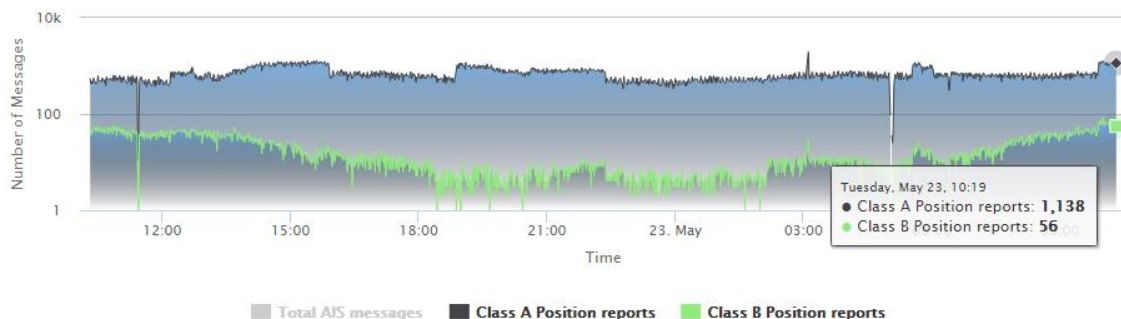
Slika 4 - Broj primljenih AIS poruka [3,11]
