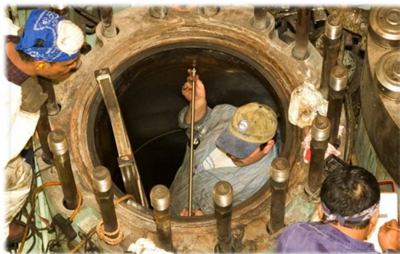
Slika 22. Mjerenje trošenja košuljice mikrometrom [1].
