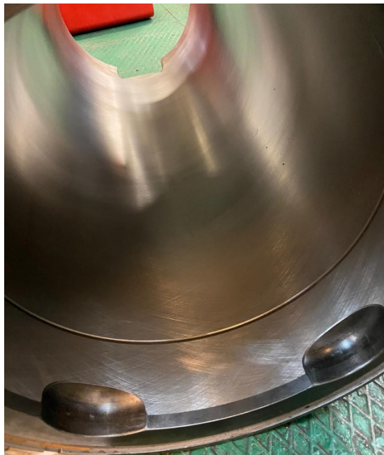
Slika 21. Honirana površina košuljice cilindra četverotaktnog motora [4]
