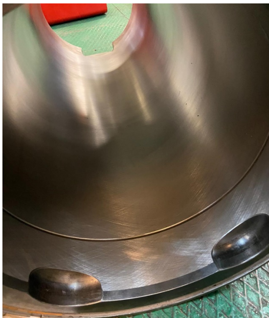
Slika 21. Honirana površina košuljice cilindra četverotaktnog motora [4]
