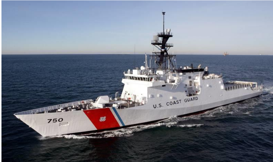
Slika 2. USCG Bertholf (WMSL – 750); brzina 28 čv, doplov 12 000 NM [10]
